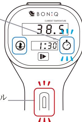
【分設定】スクロールダイアルを回し「30」に合わせる
